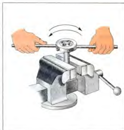
Рис. 80. Нарезание резьбы плашкой
