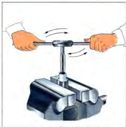
Рис. 82. Нарезание резьбы метчиком
