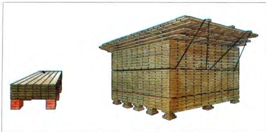
Рис. 1. Сушка пиломатериалов в штабелях
