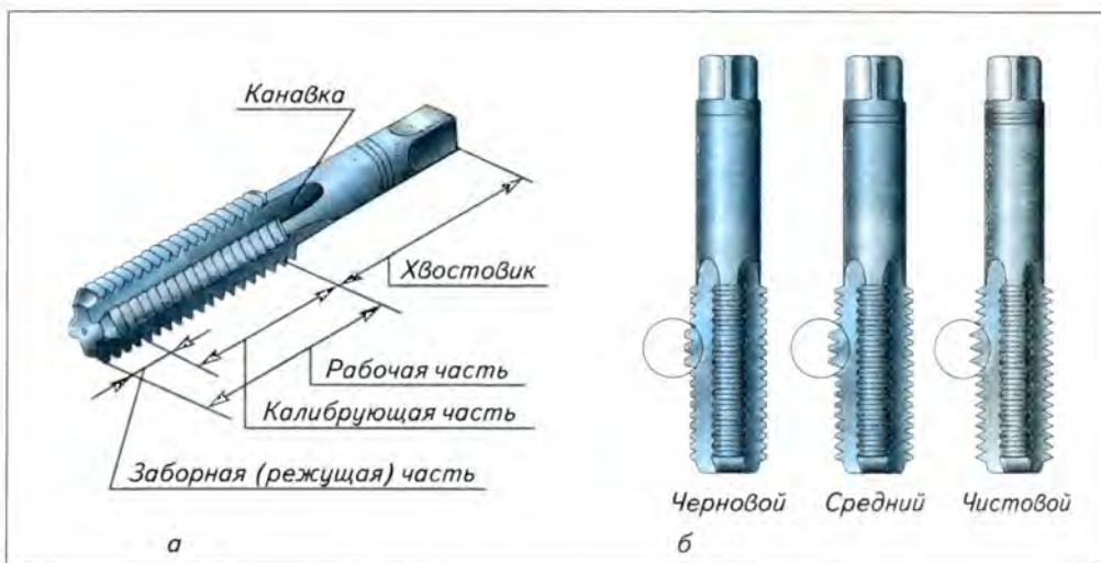
Рис. 81. Метчики: а — основные элементы; б — комплект для нарезания метрической резьбы
