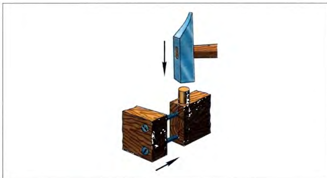
Рис. 33. Соединение деталей шурупами в нагель
