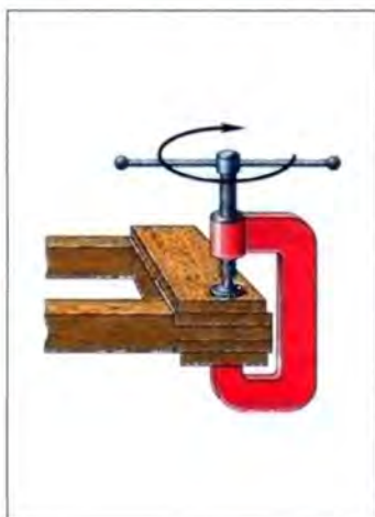
Рис. 29. Зажим шипового соединения при склеивании
