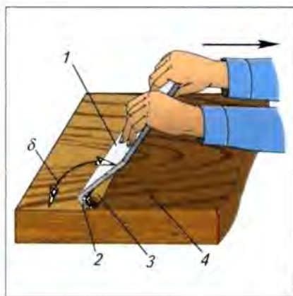
Рис. 57. Зачистка поверхности циклей: 1 — цикля; 2 — режущая кромка; 3 — стружка; 4 — зачищаемая поверхность; \delta — угол резания
